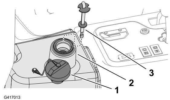
**Hinweis:** Der Füllstand sollte 6 mm von der Markierung am Peilstab liegen.
