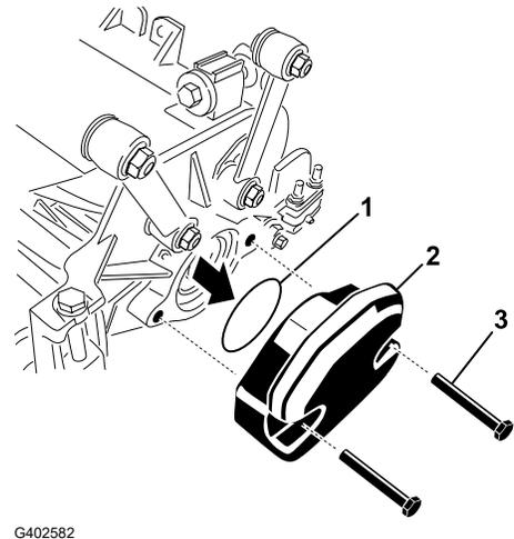
5. Setzen Sie den O-Ring <sup>①</sup> am Flansch des Antriebsmotors <sup>②</sup> ein.
