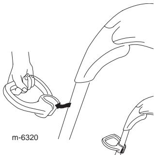
5. Montez le déflecteur de la manière indiquée, en l'enclenchant de chaque côté de la débroussailleuse.
