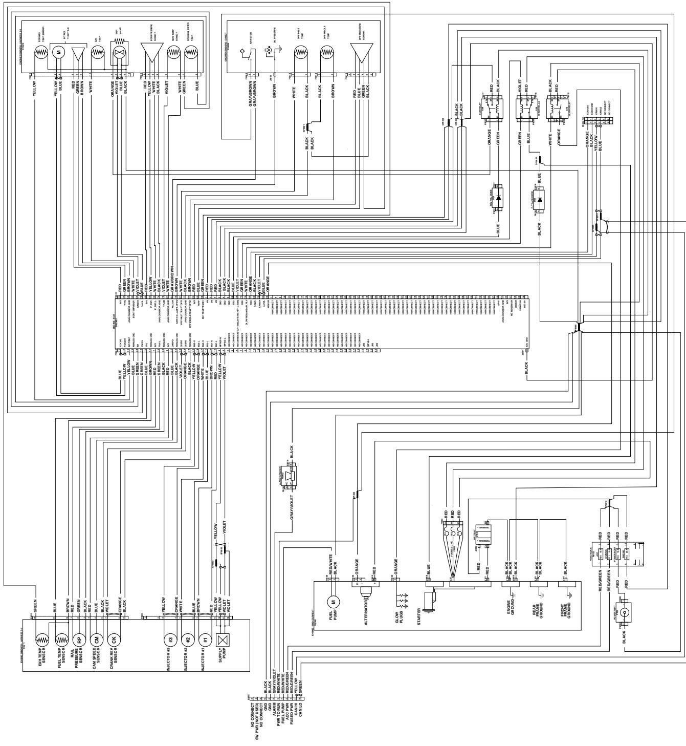
Esquema eléctrico – Motor Yanmar 3TNV88C (Rev. A)
