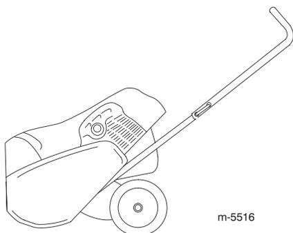
3. Montez sans les serrer les boulons de blocage du mancheron, les rondelles bombées et les boutons, comme illustré.
