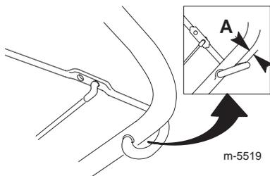
**IMPORTANT** : Le câble de commande ne doit pas être complètement tendu quand vous désengagez la barre de commande pour permettre aux pales du rotor de s'arrêter correctement.
