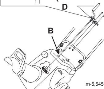
3. Fixez le support de montage au mancheron à l'aide de 2 boulons et 2 contre-écrous.
