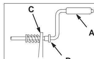
**Remarque :** Vérifiez que la bague en plastique (D) est complètement enfoncée dans le trou du support de fixation.
