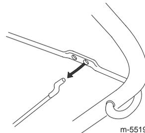
2. Accrochez le raccord en Z à un trou plus haut ou plus bas de manière à obtenir un écart de 2 à 3 mm (1/16 à 1/8 pouce) entre la barre de commande et le mancheron.
