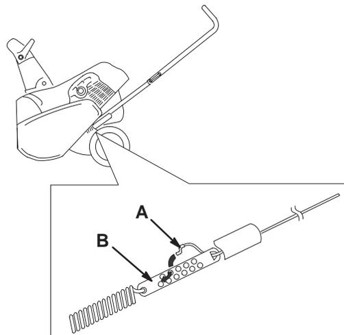
**Remarque** : Accrochez le raccord en Z plus haut pour réduire l'écart entre la barre de commande et le mancheron ; accrochez-le plus bas pour augmenter l'écart.
