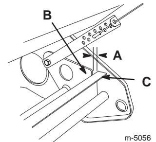
**IMPORTANT :** Si la plaque de pivot touche le cadre de roue avant que la barre de commande touche le mancheron, le câble est trop tendu.
