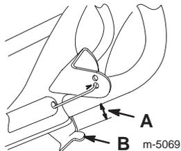
**IMPORTANT :** Le câble de commande du rotor ne doit pas être complètement tendu quand vous désengagez la barre de commande pour permettre aux pales du rotor de s'arrêter correctement.
