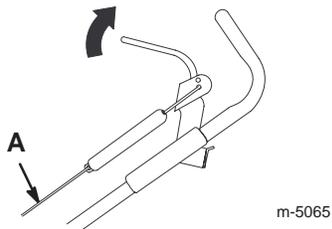
2. Vérifiez que l'écart (A) entre le support de la barre de commande (B) et le mancheron est compris entre 3 et 6 mm (1/8 à 1/4 pouce).
