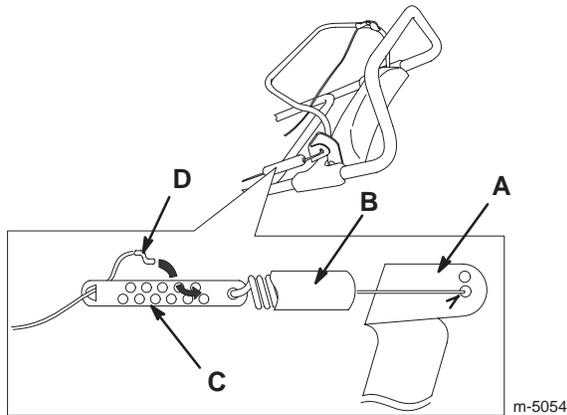
2. Remontez la protection du ressort (B) sur le dispositif de réglage du câble (C).
