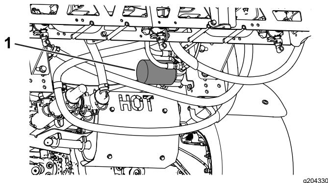
1. Hidraulični filter
