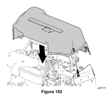
2. Enganche la cubierta del cabezal de perforación en la ubicación del cierre 4 (Figura 153).
