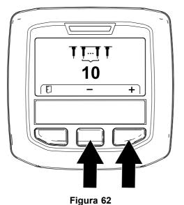
Pulse el botón izquierdo del InfoCenter para guardar los ajustes y salir de la pantalla de Set Hole Spacing (Ajustar espaciado de las perforaciones). 7. Gire la llave de encendido a la posición de APAGADO.
