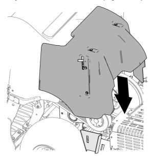
3. Baje totalmente la manivela del cierre para fijar la cubierta (Figura 146).
