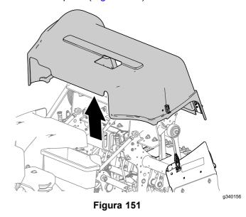
Instalación de la cubierta del cabezal de perforación
