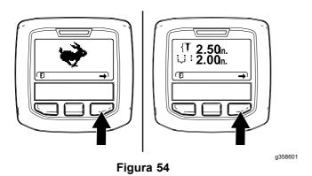
Pulse el botón derecho del InfoCenter hasta que se muestre la pantalla Setting the Hole Spacing (Ajuste del espaciado de las perforaciones) (Figura 54 y Figura 55).
