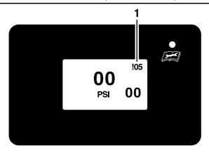
1. Fault code !05 (motor wire)
