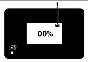
1. Fault code !05 (motor wire)
