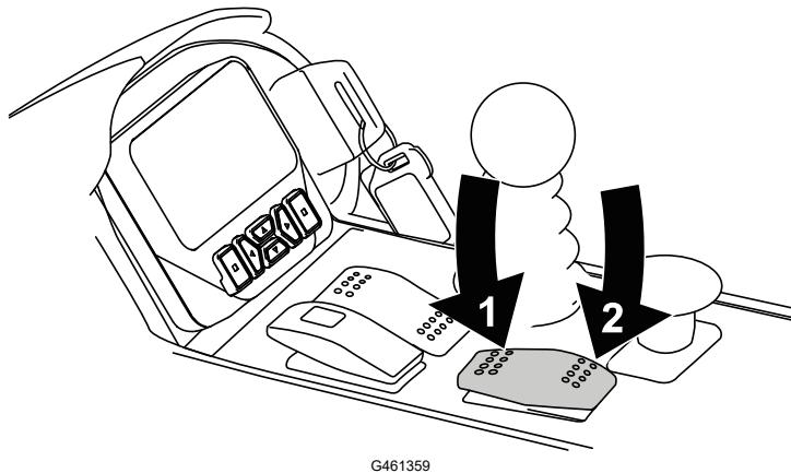
① Kratko dodirnite prekidač unapred da povećate brzinu motora u koracima od 100 o/min; pritisnite i držite da postavite motor na prazan hod visoke brzine
