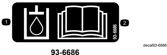
1. Hidraulična tekućina
