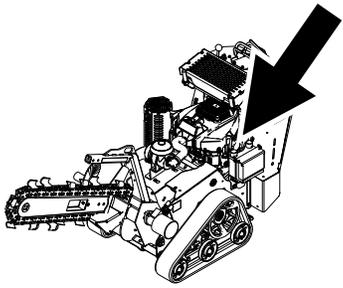
**Hinweis:** Stellen Sie sicher dass die Ölfilterdichtung den Motor berührt und drehen Sie den Ölfilter dann um eine weitere Dreivierteldrehung.
