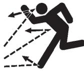
Weggeschleuderte bzw. hochfliegende Gegenstände — Sichelmäher mit Seitenauswurf. Prallschutz nicht abmontieren
