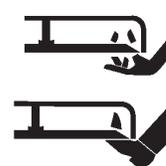
**Um Messerschäden beim Mulchen zu vermeiden, Messerverstärker verwenden, falls Mäher mit Mulcheneinsatz ausgerüstet ist**
