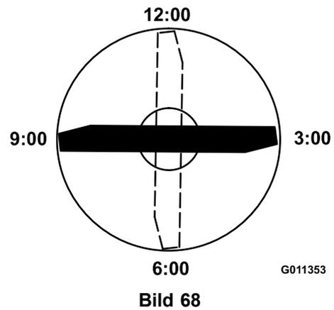
4. Drehen Sie die markierte Seite des Messers auf die 3- und die 9-Uhr-Stellung und messen Sie die Höhe ([Bild 68](#)).
