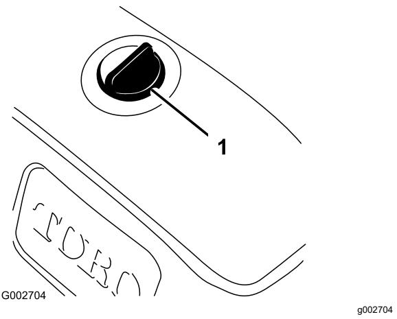
1. Čep spremnika hidraulične tekućine
