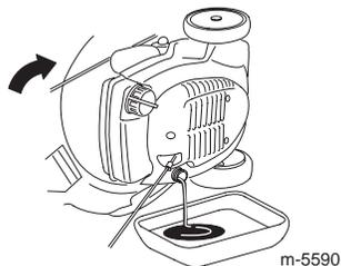
3. Vierta **lentamente** aceite en el tubo de llenado hasta que el nivel llegue a la marca **Full** de la varilla. **No llene demasiado.** (Capacidad máxima: 0,59 litros (20 onzas), tipo: SAE 30W, aceite detergente con clasificación de servicio API SF, SG, SH, SJ, SL o superior.)
