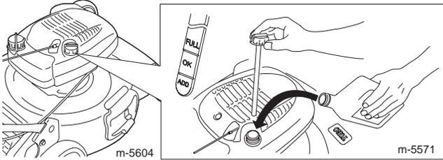
2. Retire la varilla y compruebe el nivel de aceite. Si el nivel de aceite está por debajo de la marca **Add** de la varilla, vierta **lentamente** aceite en el tubo de llenado hasta que el nivel llegue a la marca **Full** de la varilla. **No llene demasiado.** (Capacidad máxima: 0,59 litros (20 onzas), tipo: SAE 30, aceite detergente con clasificación de servicio API SF, SG, SH, SJ, SL o superior.)
