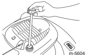
2. Vuelque el cortacésped hacia su lado **derecho** para drenar el aceite usado a través del tubo de llenado de aceite.
