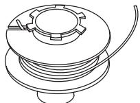
3. Enrolle la cuerda en el sentido que marca la flecha del carrete, de forma homogénea, en el canal del carrete.
