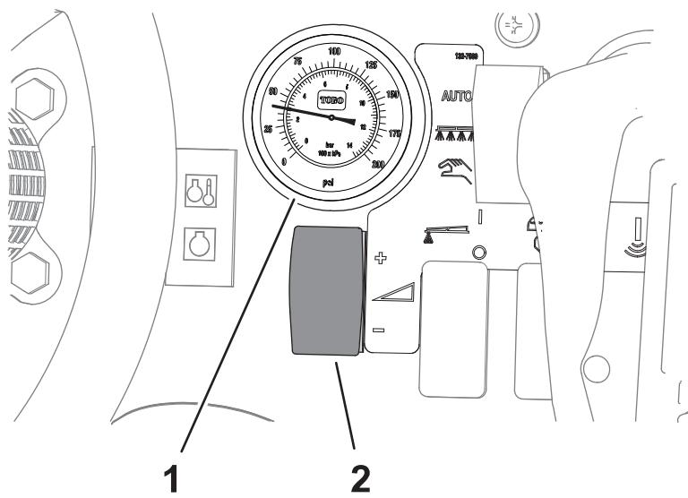
① 散布装置の水圧計
