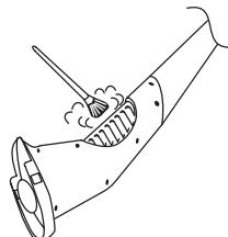
**IMPORTANTE:** Mantenga las entradas de aire libres de hierba y suciedad para evitar que se sobrecaliente el motor.
