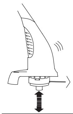
**Nota:** La cuchilla situada debajo del protector cortará la cuerda automáticamente a la longitud correcta.
