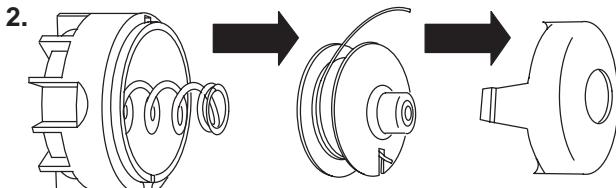
**Nota:** Si el muelle se cae del cabezal de corte durante este procedimiento, instale el muelle antes de instalar el carrete y la tapa.
