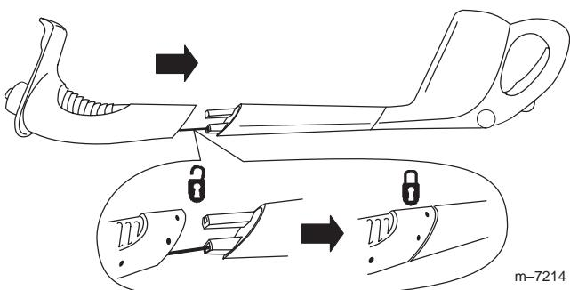
3. Instale la parte superior de la empuñadura según muestra la ilustración, usando el perno largo y el pomo.
