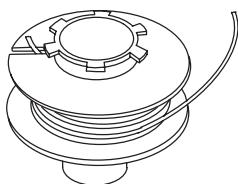
**Nota:** La desbrozadora no funcionará correctamente si la cuerda se enrrolla en sentido contrario, si el extremo de la cuerda sobresale más de 3 mm, o si la cuerda se enrrolla sobre pasando el borde exterior del carrete.
