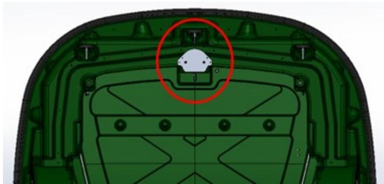
Cette antenne GNSS spécifique est montée au centre à l'avant de la coque. Elle permet de recevoir les données sur la position mondiale du robot envoyées par les satellites.
