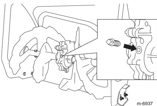
3. Retirez le bouchon de tuyau du boîtier d'engrenages.
