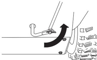
6. Soulevez la tige de commande de vitesse et insérez le tourillon dans l'orifice qui se trouve sur la surface inférieure du sélecteur de vitesses (D) situé sous le panneau de commande
