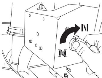
5. Insérez la clé de contact dans le commutateur d'allumage.
