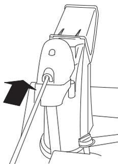
6. Alignez les trous dans les extrémités réunies des tiges et insérez 2 boulons de carrossier dans la tige courte par le côté gauche de la déneigeuse (vue depuis la position d'utilisation).
