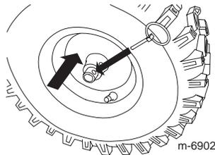
Pour que la machine se propulse automatiquement, glissez les roues vers l'extérieur et insérez les goupilles des essieux dans les trous des moyeux et les trous intérieurs des essieux.
