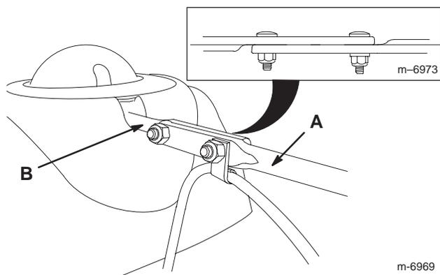
5. Tenez la longue tige de commande de l'éjecteur dans ce sens (il faut la ramener en arrière pour l'introduire dans le pignon) et insérez l'extrémité avant de la tige dans l'ouverture à l'arrière du couvercle du pignon jusqu'à ce qu'elle entre dans le pignon.
