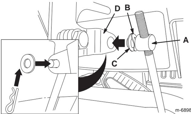
**Remarque :** Pour faciliter le montage, laissez la rondelle ondulée (B) et la rondelle plate (C) sur le tourillon.
