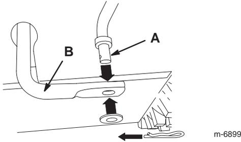
2. Fixez l'extrémité inférieure de la tige de commande de vitesse avec la rondelle et la goupille fendue retirées précédemment.
