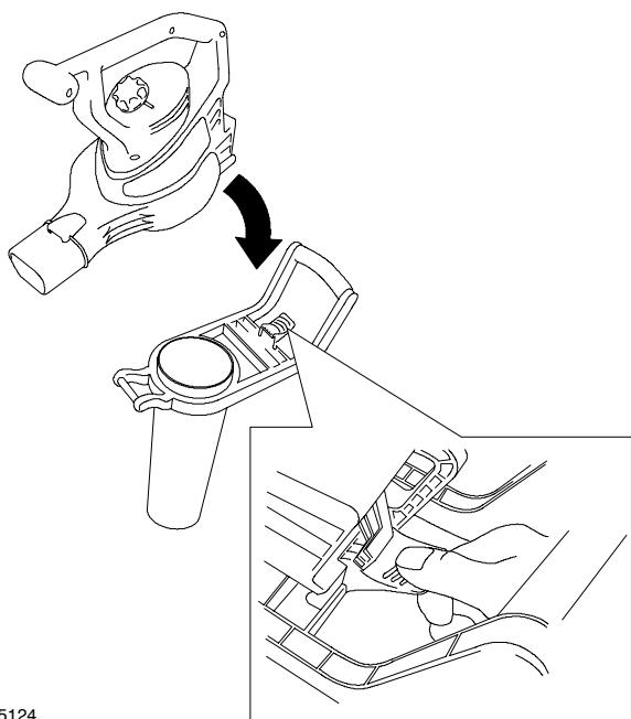
**IMPORTANT :** L'aspirateur ne fonctionnera que si le tube d'aspiration est verrouillé en position.
