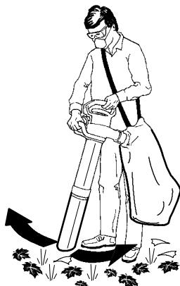
**IMPORTANT :** Ne poussez pas le tube d'aspiration en forçant dans une pile de débris et ne retournez pas l'appareil pour introduire des débris de force dans le tube. Dans les deux cas, la turbine risque de se boucher et d'être endommagée. Si l'aspirateur se met à vibrer ou produit des bruits inhabituels, arrêtez-le, **débranchez** le cordon d'alimentation et recherchez l'origine du problème.
