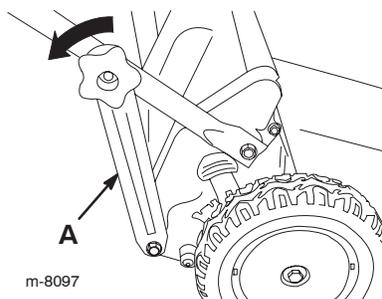
**Remarque :** Accrochez les boutons de la partie inférieure du guidon aux boulons du guidon pour éviter de les perdre.
