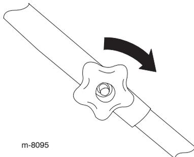
3. Faites pivoter le guidon en arrière.
