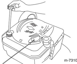
2. Inclinez la tondeuse sur le côté (filtre à air en haut) pour vidanger l'huile usagée par le goulot de remplissage.
