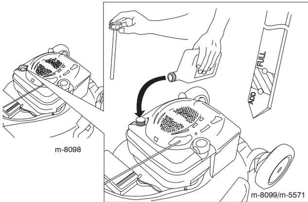
2. Versez de l'huile **lentement** dans le goulot de remplissage pour faire monter le niveau de liquide jusqu'au repère du plein (**Full**) sur la jauge. **Ne remplissez pas excessivement.** (Remplissage max. : 600 ml (20 onces), type : huile détergente SAE 30W de classe de service API SF, SG, SH, SJ, SL ou supérieure).
