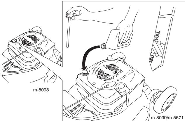
2. Sortez de nouveau la jauge et vérifiez le niveau d'huile. Si le niveau n'atteint pas le repère minimum (**Add**) de la jauge, versez **avec précaution** suffisamment d'huile dans le goulot de remplissage pour faire monter le niveau au repère maximum (**Full**). **Ne remplissez pas excessivement.** (Remplissage max. : 600 ml (20 onces), type : huile détergente SAE 30W de classe de service API SF, SG, SH, SJ, SL ou supérieure).
