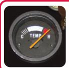
COOLANT TEMPERATURE **GAUGE READS ABOVE** 220° F (105° C) NORMAL RANGE 175°- 220° F (80°-104° C)
