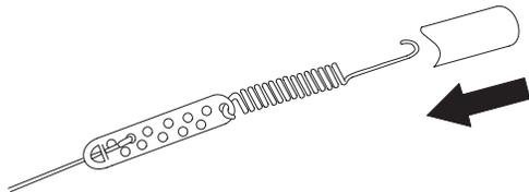
7. Accrochez le ressort de câble dans le trou inférieur de la barre de commande.
