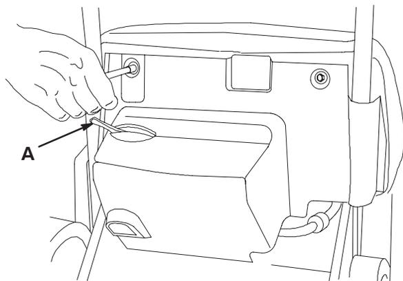
2. Tirez le haut du carénage en arrière jusqu'à ce que la manette de starter (A ci-dessus) passe par la fente.
