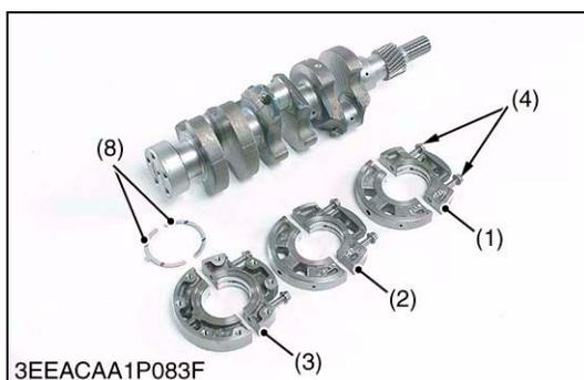
**Main Bearing Case Assembly (Z602-E2B, D902-E2B)**
