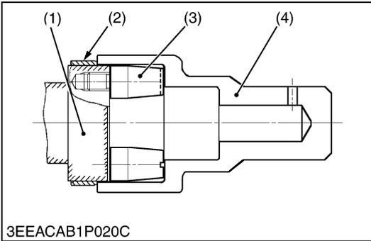
**Replacing Crankshaft Sleeve (Z482-E2B, D662-E2B, D722-E2B, D782-E2B)**
