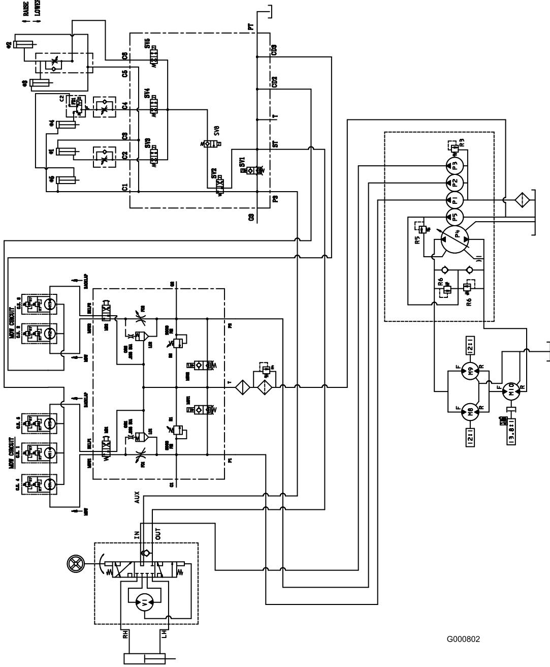
油圧回路図(モデル 03807) (Rev. -)
