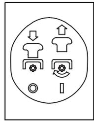
**REMARQUE:** Le bouton de la prise de force **doit** se trouver à la position OFF (non enclenchée) lors de la mise en route du moteur.
