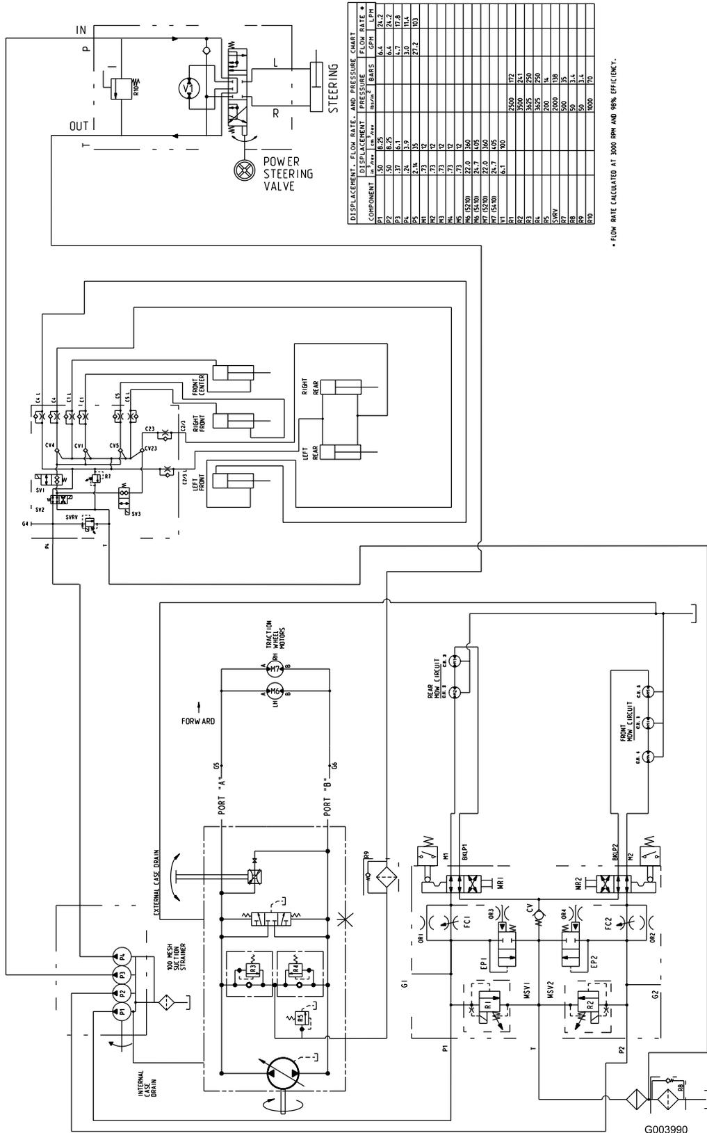
Esquema hidráulico, modelo 5210 e 5410 (Rev. A)
