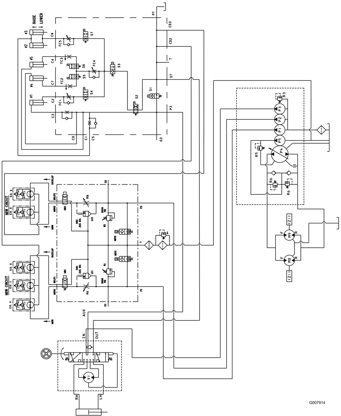
Schema idraulico del modello 03806 (Rev. -)
