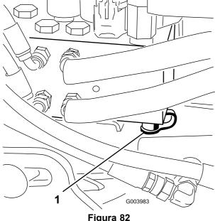
Punto de prueba del circuito de elevación
