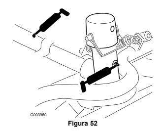
• Eje pivotante del brazo de elevación (1 en cada) (Figura 53)
