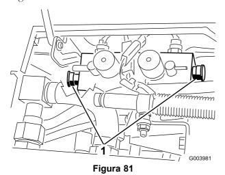
1. Puntos de prueba del circuito de siega (2)
