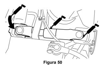
Cilindros del brazo de elevación de la unidad de corte (2 en cada) (Figura 51)
