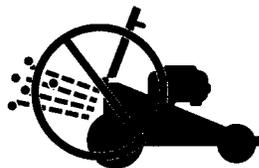
Öffnen Sie die Auswurfür des Mähers nie, bei laufendem Motor, wenn der Grassack nicht montiert ist
