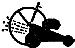
Het uitlaatdeurtje op de maaimachine nooit open maken als de motor draait, tenzij de graszak op zijn plaats zit
