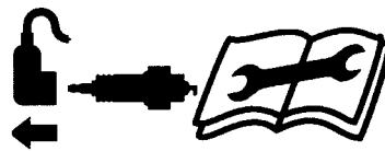
Trek de draad van de bougie en lees de bedieningshandleiding voordat u onderhouds- of verstelwerkzaamheden uitvoert
