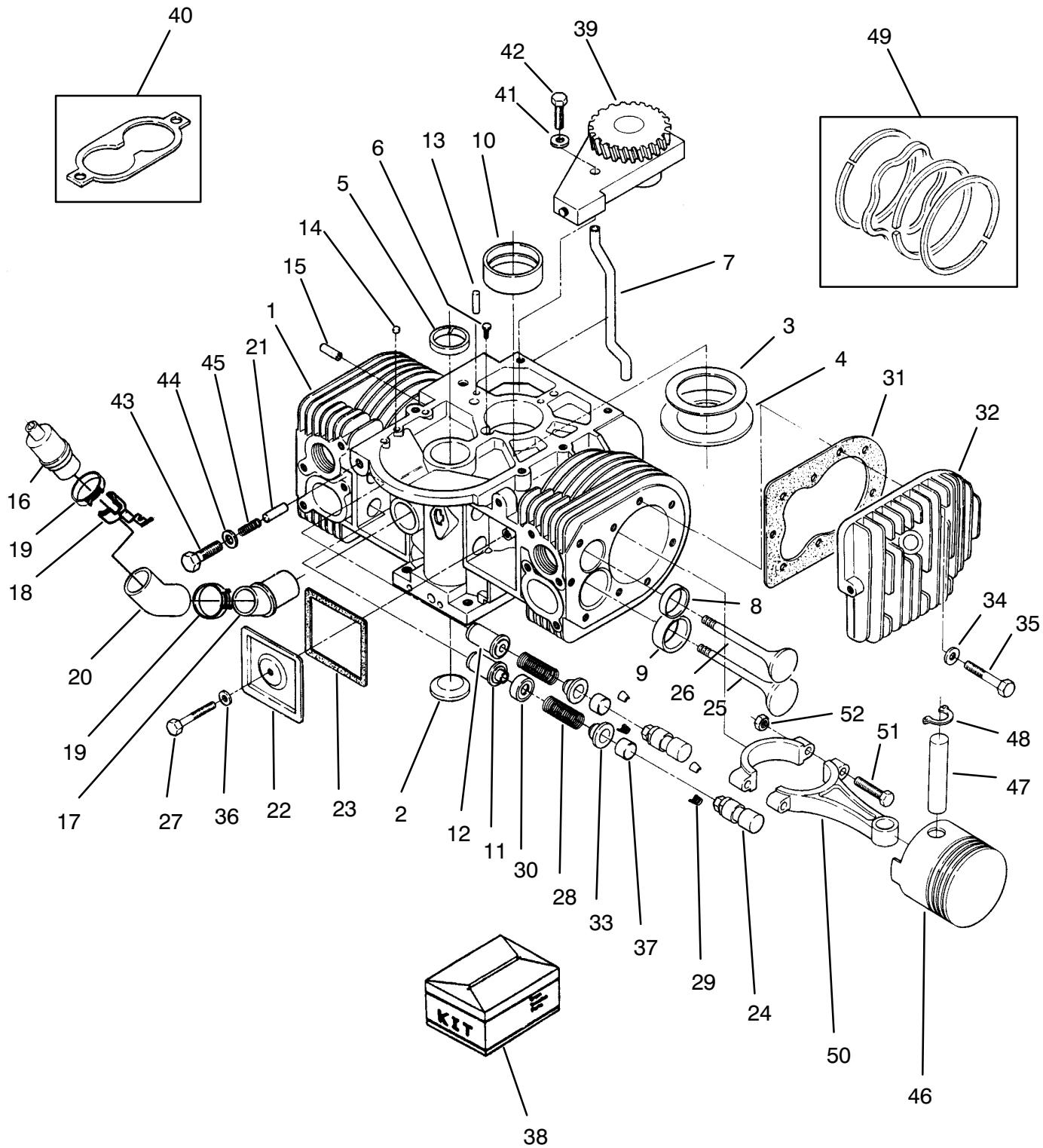
**ENGINE CYLINDER BLOCK ASSEMBLY**
