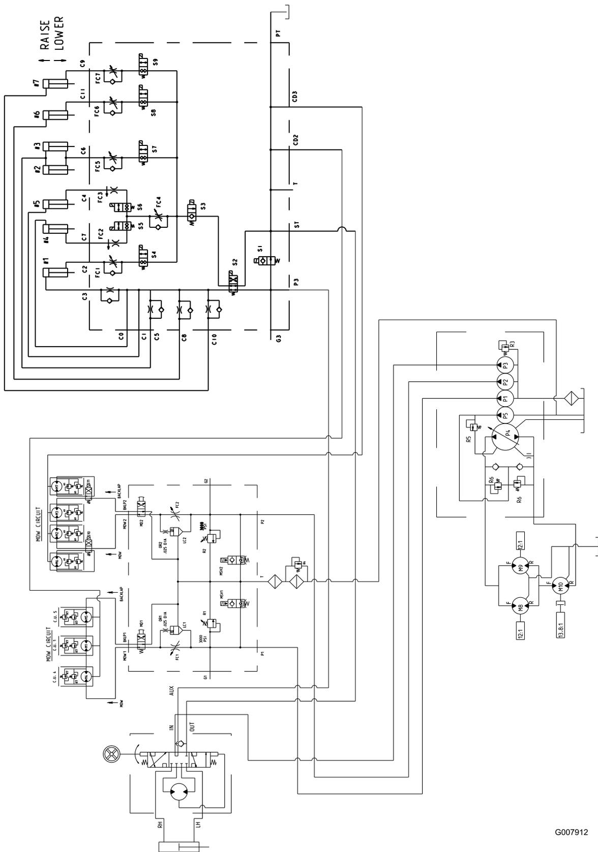
Schéma hydraulique, modèles 03808 et 03813 (Rev. A)
