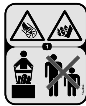
1. В связи с опасностью выброса осколков, разрушения крыльчатки и шнека посторонние лица должны находиться на безопасном расстоянии от работающего снегоочистителя.
