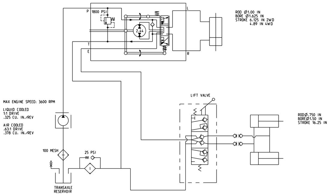
Гидравлическая схема (Rev. B)
