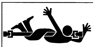
HELE KROPPEN KAN KOMME I KLEMME I REDSKABETS INDGANGSAKSEL
