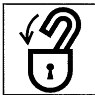
FØR MAN KOMMER IND I FAREZONEN, SKAL SIKKERHEDSLÅSEN SÆTTES PÅ
