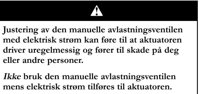
I nødtilfeller som gjør at bommen må flyttes og ingen 12 V DC-strømkilde er tilgjengelig, kan den manuelle avlastningsventilen brukes til å avlaste trykket inne i aktuatoren og tillate at bommene kan flyttes manuelt.
