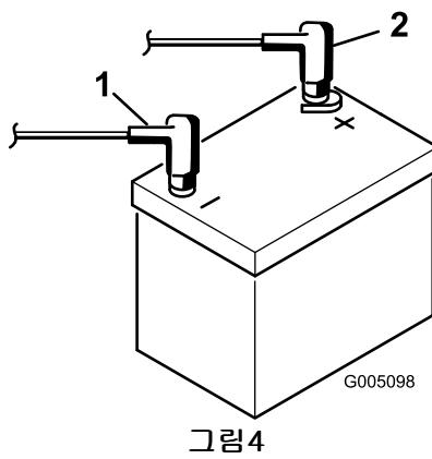
1. 양극(+) 배터리 케이블      2. 음극(-) 배터리 케이블
