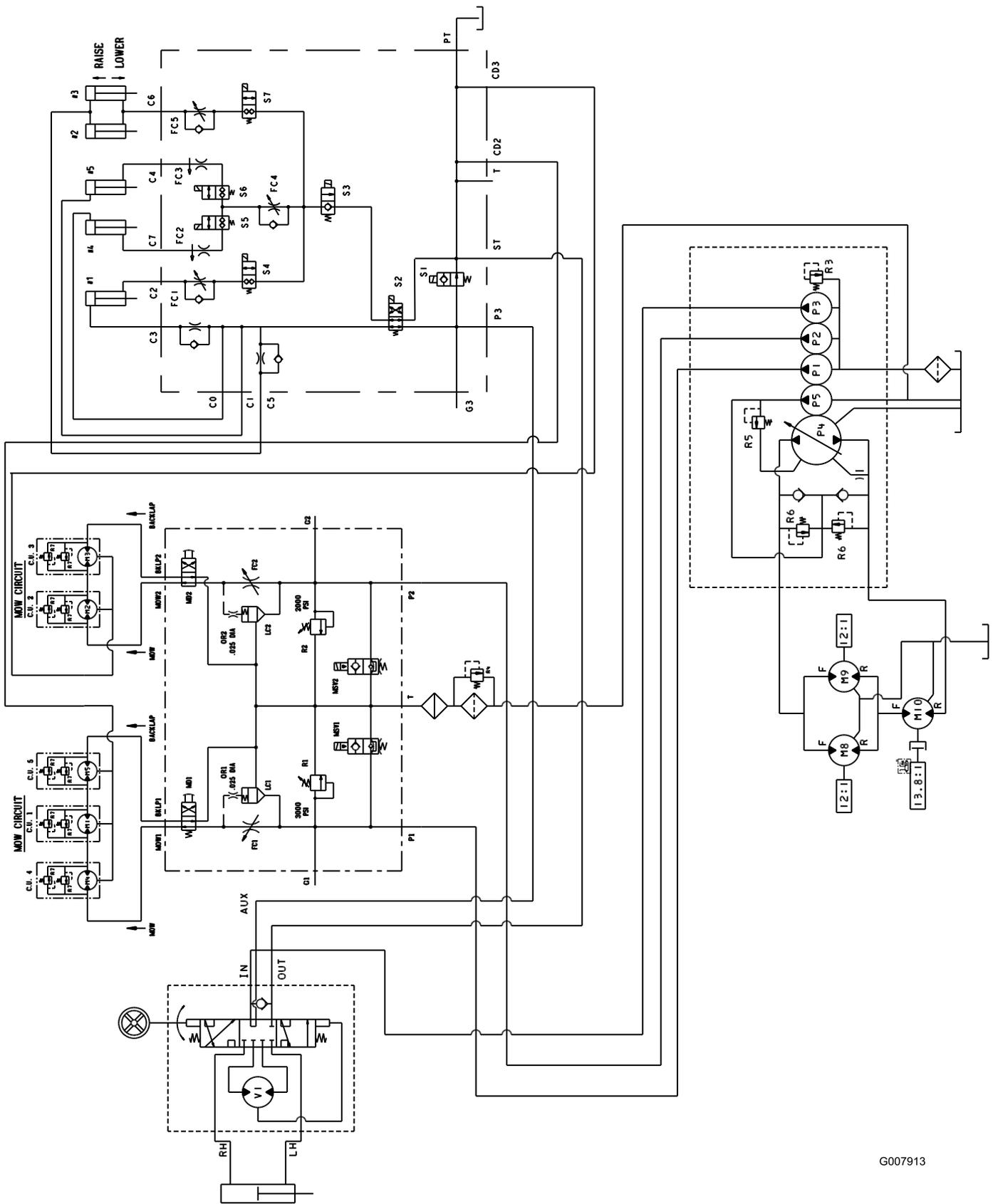
Schema idraulico del modello 03807 e 03812 (Rev. -)
