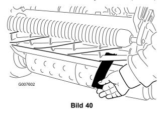
**Hinweis:** Jedes Mal, wenn Sie die Einstellschraube um einen Klick im Uhrzeigersinn drehen, wird der Abstand zwischen Untermesser und Spindel um 0,0017 cm verringert. Ziehen Sie die Einstellschrauben nicht zu fest.
