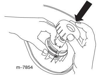
3. Coloque la tapa firmemente girándola en el sentido de las agujas del reloj.
