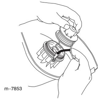
2. Sujetando la cuerda y el carrete, coloque la tapa en el carrete.
