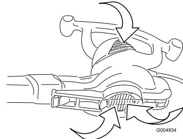
**Attention—Pièces en mouvement**—n'utilisez pas la machine si le déflecteur d'entrée d'air n'est pas en place. Consultez la rubrique Préparation pour connaître les instructions de montage correctes.
