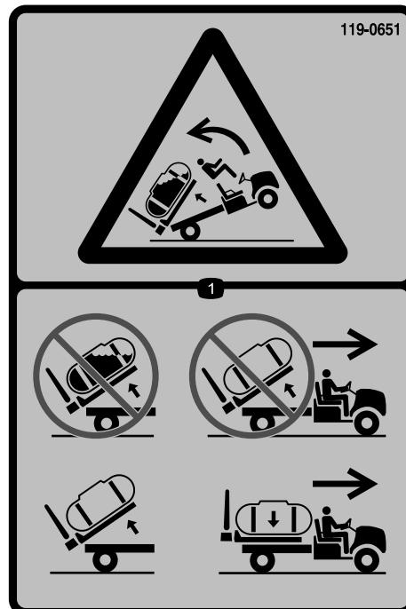
1. 転倒して制御不能になる危険：液剤を入れた状態でタンクを上昇させないこと；タンクを上昇させたままで車両を走行させないこと。タンクが空のとき以外はタンクを上昇させないこと；車両を走行させるときには必ずタンクを一番下の位置まで降下せること。
