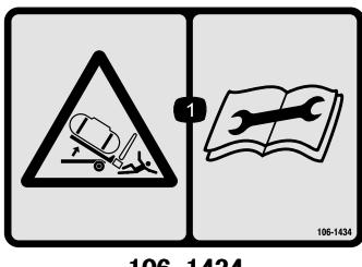
1. タンク・アセンブリが落下して押しつぶされる危険：整備の前にオペレーターズマニュアルを読むこと。
