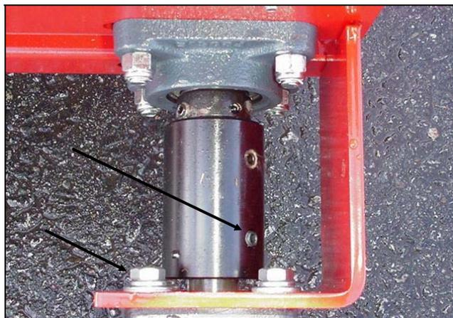
Figure 20 : Montage des boulons et serrage des vis
