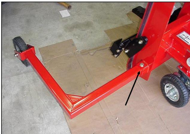
**Figure 12 : Montage des pieds sur le chariot pour accessoire**
