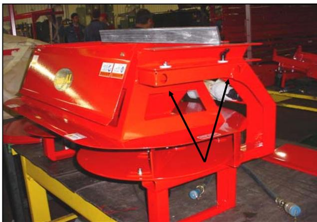
Figure 15 : Ouvertures des poignées du Twin Spinner
