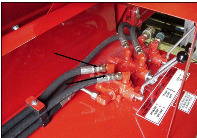
**Figure 29 : Débrancher et mettre au rebut le flexible hydraulique le plus éloigné**
