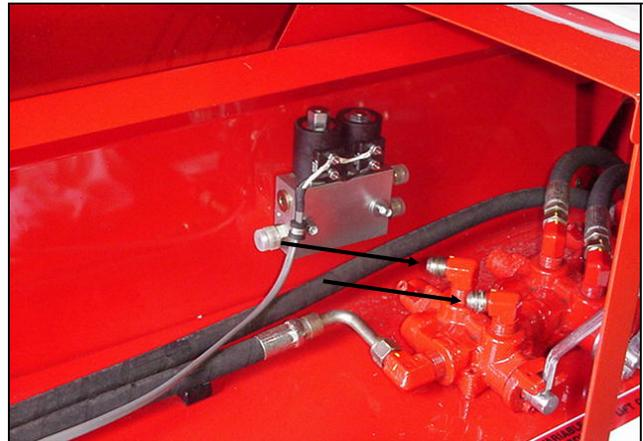
**Figure 30 : Déposer les raccords hydrauliques**
