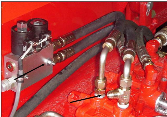
**Figure 37 : Raccordement du flexible (7) et des raccords d'extrémité aux points A et B**
