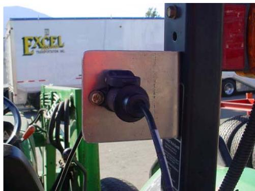
**Figure 47 : Fixez le faisceau de câblage de batterie SH au faisceau de câblage de solénoïde**
