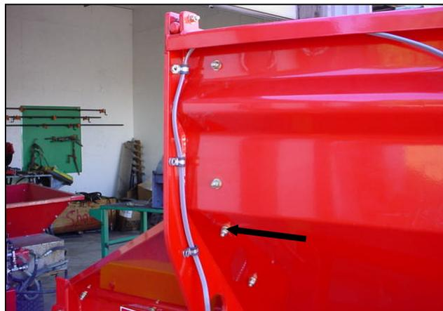
**Figure 70 : Retirez le boulon du support de feu arrière**
