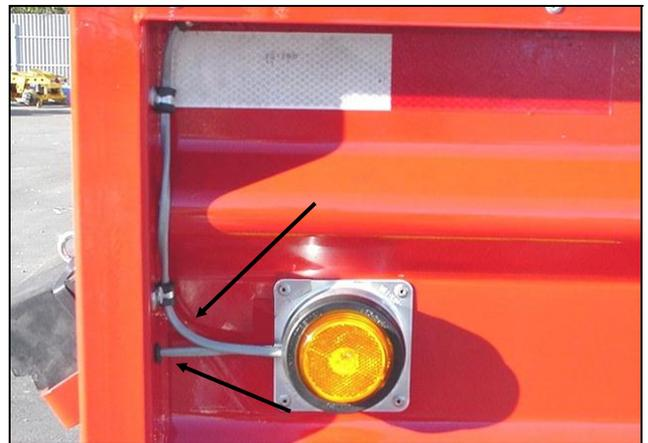
**Figure 75 : Câblage du feu de gabarit avant**
