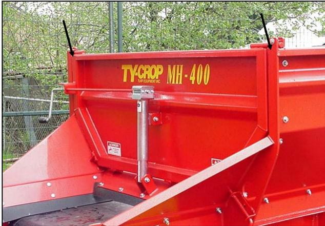
**Figure 8 : Retirer les boulons et écrous du panneau arrière**
