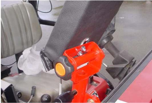
**Figure 48 : Support du boîtier de commande EH**
