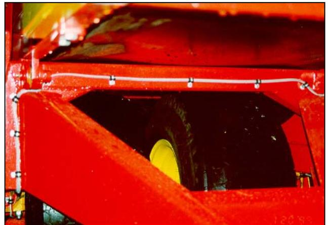
**Figure 62 : Acheminement des câbles du côté gauche vers le haut et sous le point de pivot du MH-400**
