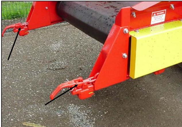
**Figure 4 : Poser les fixations de l'accessoire**
