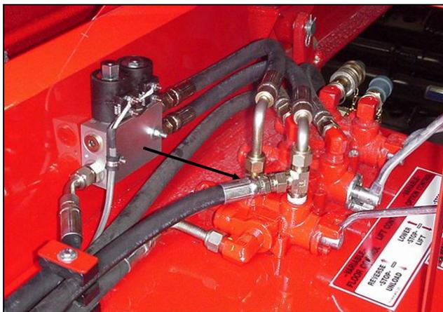
**Figure 33 : Rebrancher le flexible sur le côté du raccord en T**
