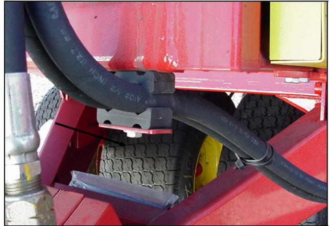
**Figure 38 : Dépose du collier de flexible hydraulique**
