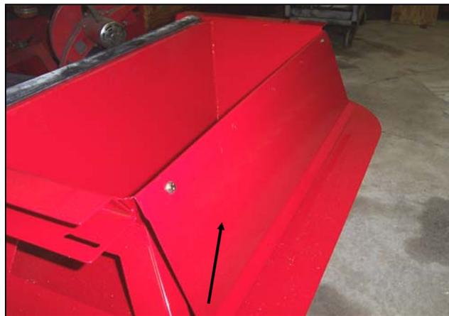
Figure 17 : Protection avant de la benne
