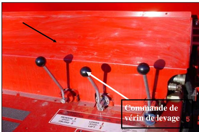
**Figure 26 : Dépose du couvercle du distributeur hydraulique et de la protection hydraulique**
