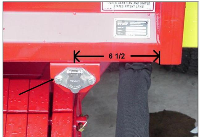
**Figure 42 : Fixez le support de montage de la prise électrique**
