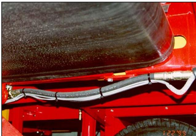
**Figure 63 : Acheminement du câble le long des flexibles hydrauliques jusqu'à la prise à 7 broches**
