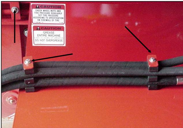
**Figure 28 : Dépose des colliers et fixations des conduites hydrauliques**
