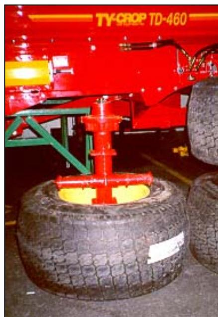
Figure 55 : Placez les ensembles pneus et essieux à plat
