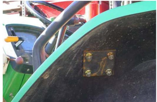
**Figure 50 : Plaque d'appui du support du boîtier de commande EH**
