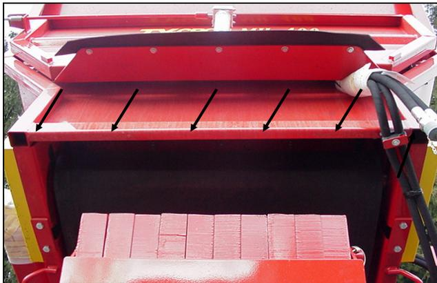
**Figure 73 : Percez des trous sur le rebord du panneau avant**
