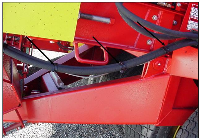
**Figure 39 : Espacez et fixez le faisceau de câblage gris**
