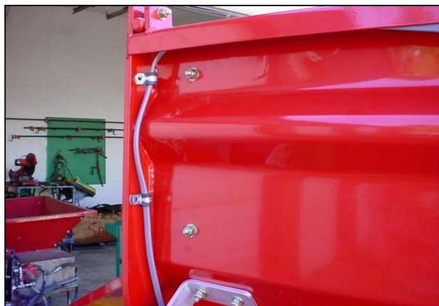
**Figure 76 : Câblage du feu arrière**
