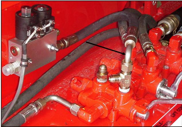
**Figure 36 : Raccordement du flexible (6) et du raccord d'extrémité au point B**
