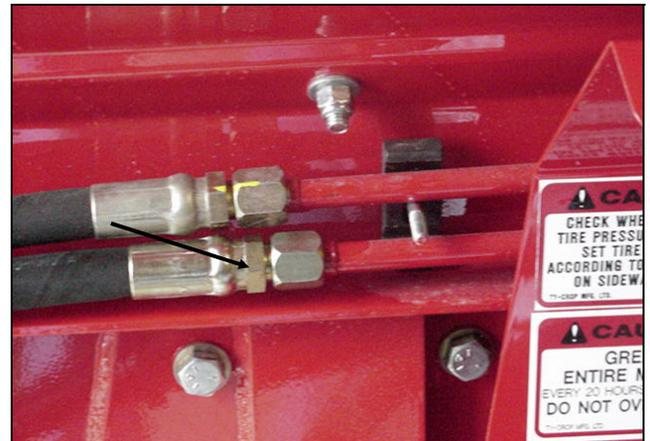
**Figure 34 : Raccordement du flexible (8) à la conduite rigide ouverte**
