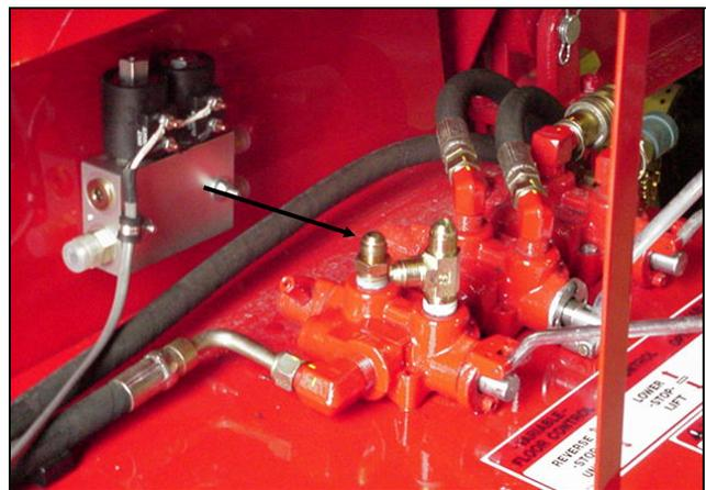
**Figure 31 : Poser le raccord sur l'orifice de distributeur intérieur**
