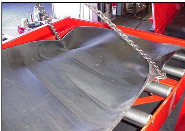
**Figure 83 : Attacher et déposer la cartouche de bande**
