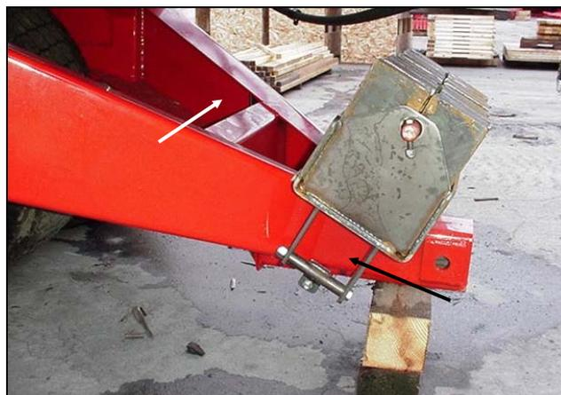
**Figure 3 : Retirer les boulons du support de montage du boîtier de masses**
