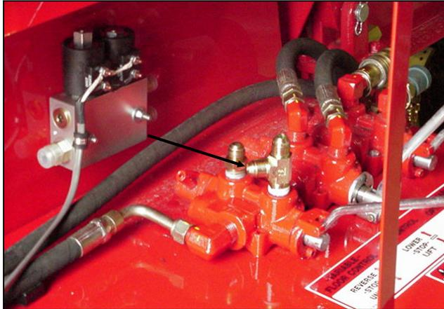
**Figure 32 : Pose du raccord en T sur l'orifice de distributeur extérieur**
