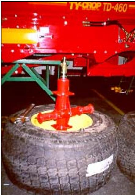
**Figure 56 : Dépose de l'ensemble moyeu**
