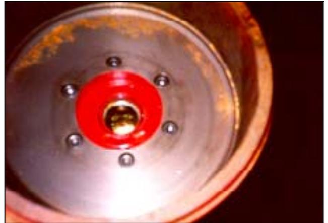
**Figure 57 : Pose de l'ensemble moyeu sur le tambour**
