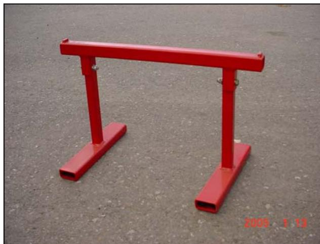
Figure 21 : Supports de rangement du transporteur transversal
