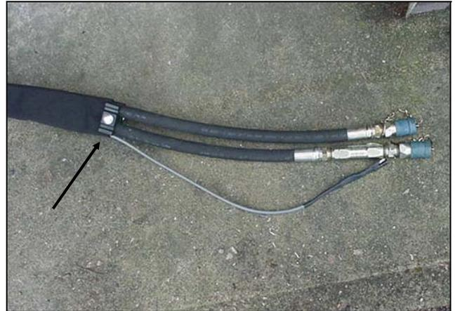
**Figure 41 : Tirez les flexibles bien droits et serrez en position**
