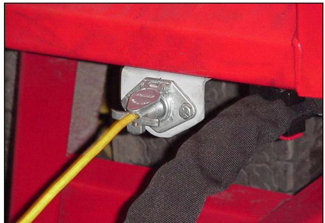
**Figure 11 : Brancher le boîtier de commande sur les modèles SH**
