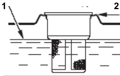
1. Nivel máximo de combustible 2. Parte superior del depósito de combustible
