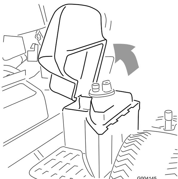
3. Pulite attorno al collo del bocchettone e del tappo del serbatoio idraulico (Figura 37). Togliete il tappo dal collo di riempimento.
