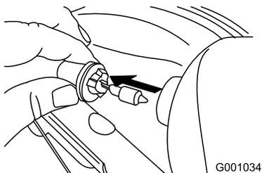
4. Introduisez une ampoule neuve dans le phare par l'arrière (Figure 66).
