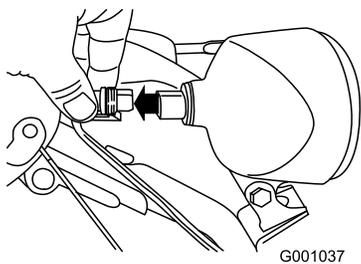
2. Tournez la base de l'ampoule dans le sens anti-horaire jusqu'à la butée (Figure 64).
