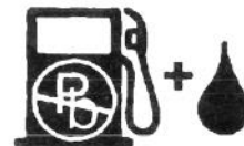
50:1 Mischverhältnis, bleifreies Benzin zu Zweitaktöl
