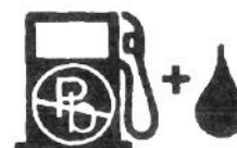
50:1 Verhouding tussen loodvrije benzine en tweetaktolie
